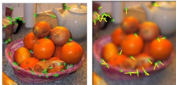
**Рисунок 1:** Базовое отслеживание точечных особенностей. Изображение справа получено с помощью параллельного переноса и искусственного расфокусирования изображения. Отметим ошибки в определении движения особенностей – они должны быть одинаковыми
